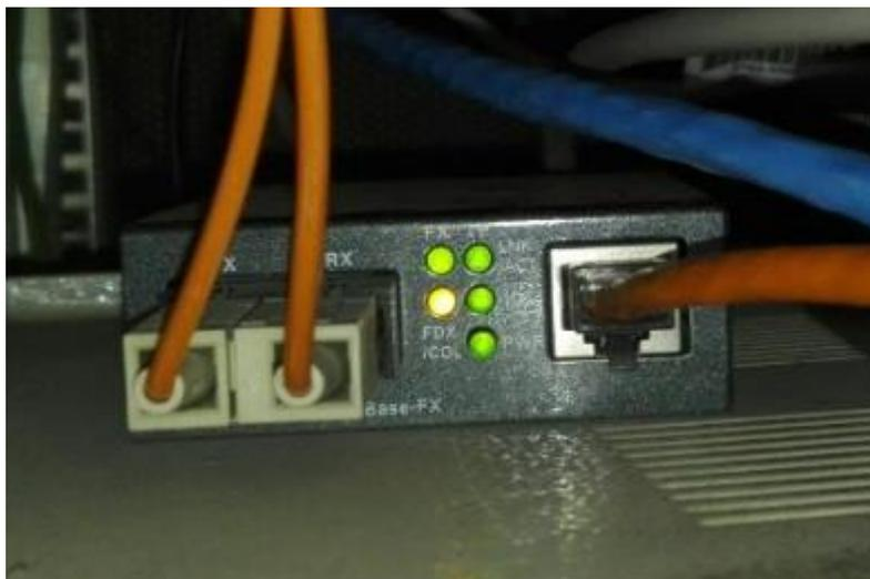
Ilustración 28. Conversor optoelectrónico.
