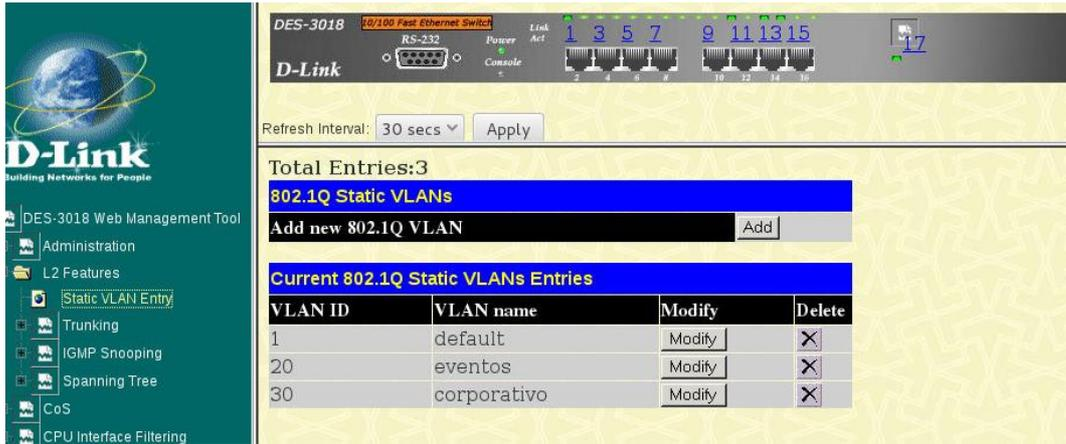
Ilustración 40. Interfaz para configurar las 3 VLANs.
