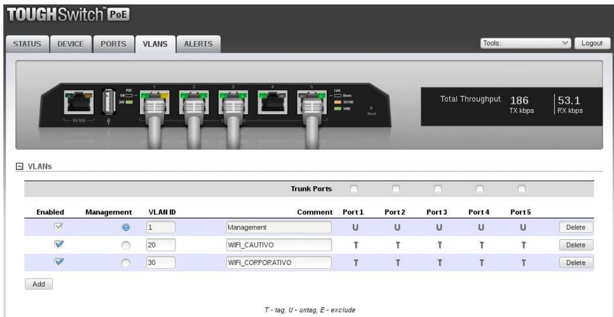
Ilustración 44. Configuración de los puertos para cada VLAN.
